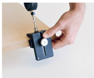
2. Пробиване на 6 мм отвор
