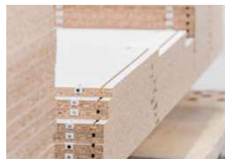
2. Поставете сглобките в отворите. 3. Транспортирайте плоскостите една върху друга
