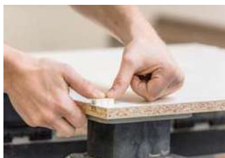
2. Поставете сглобките в отворите. 3. Транспортирайте плоскостите една върху друга
